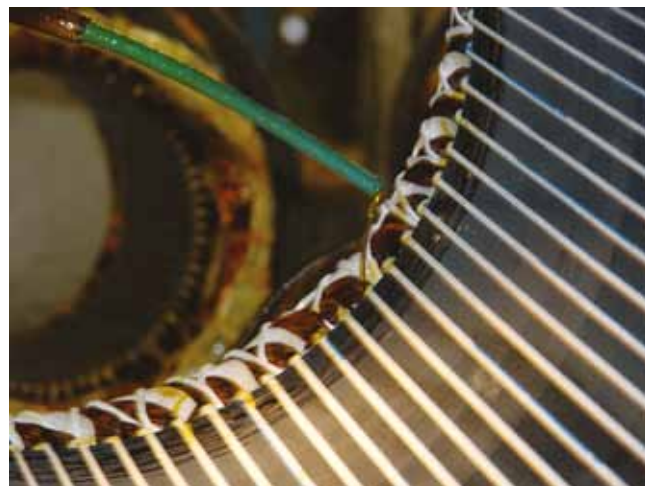
Figura 1.12.c - Flujo continuo de resina.
